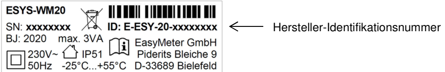
Abbildung 3: Zusatzschild auf der Oberseite des Wireless M-Bus Moduls (beispielhaft)
