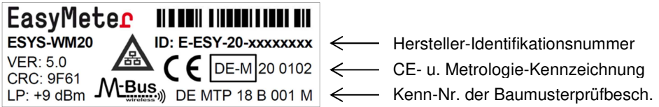
Abbildung 2: Leistungsschild auf der Vorderseite des Wireless M-Bus Moduls
